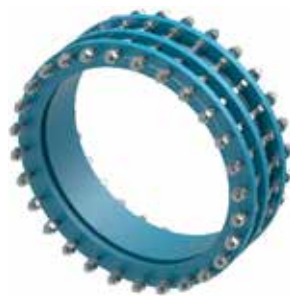
Innbyggingsstykke V7-10F Body GJS-400-15 EPDM tetning A2 bolter Toleranse \pm 25 DN700 - DN1200
