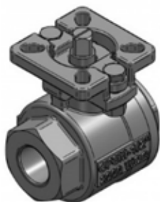
60° V-port kuleventil Materiale SS316 | Super duplex Tetninger i 316/PTFE ISO-toppflens Gjenget BSP DN15 – DN80
