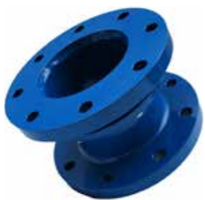
Innbyggingsstykke 44A Body Karbonstål | AISI 304 EPDM tetning Galvaniserte bolter Toleranse \pm 30 - 40 DN50 - DN1600
