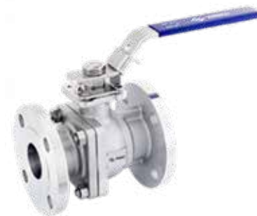
Kuleventil CF8M Full bore Tetninger i PTFE ISO-toppflens DIN Flens DN15 – DN100
