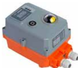
Elektrisk Aktuator Part-turn ISO 5211 Monteringsflens On/Off | Modulerende Torque output | max. 400Nm
