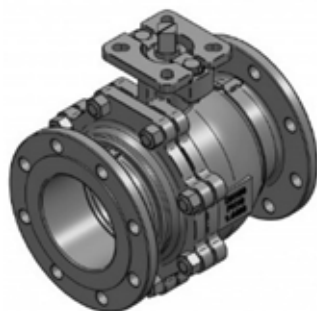
60° V-port kuleventil Materiale SS316 | Super duplex Tetninger i 316/PTFE ISO-toppflens DIN Flens DN15 – DN150
