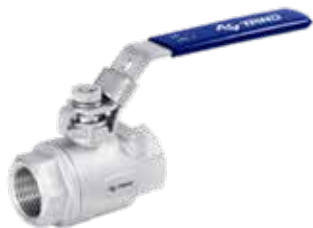
Kuleventil CF8M Full bore Tetninger i PTFE Gjenget BSP DN08 – DN100
