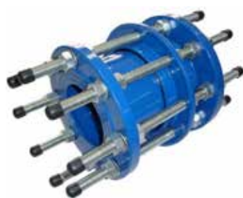
Innbyggingsstykke 44A Body GJS-500 EPDM tetning Galvaniserte bolter Toleranse \pm 30 - 40 DN50 - DN1600
