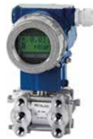
Nipress DD (differansetrykk) IP54/65/67 Målecelle | Silicon | 316L Range | 0-70bar Nøyaktighet | 0,075 - 1% Output | 4-20mA | HART
