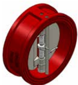
Dobbelklafftilbakeslag Mykttettende | Metalltettende Body GGG 40 Spjeld 316 | Duplex Wafer DN50 – DN700
