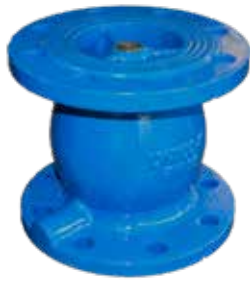
Aksial-disk tilbakeslag Body GJS500 Fjær 304 | 316 Disk | GJS500 + EPDM DIN Flens DN50 – DN600
