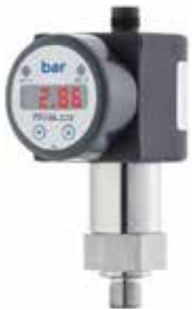
Nipress DK IP54/65/67 Målecelle | Silicon | Keramisk | 316L Range | 0-60bar | 0-600bar Nøyaktighet | 0,5% Output | 4-20mA
