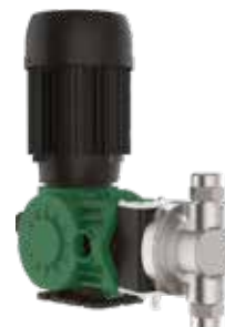
Pumpe med fjær-retur Flow rate | 1.5 – 1200 l/h Mottrykk | Maks 20bar Membran eller stempel pumpe Materiale | PP | PVC | PVDF | SS316L | PTFE
