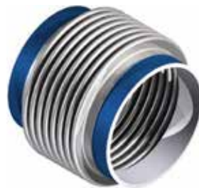
Stålkompensator Sveiseender Designtrykk | 16 bar PN10 DN40 – DN400
