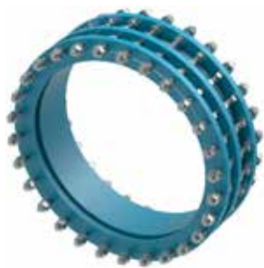
Innbyggingsstykke V7-10V Body GJS-400-15 EPDM tetning A2 bolter Toleranse \pm 15 DN50 - DN600
