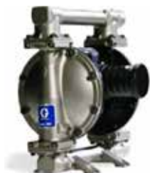
Pneumatisk dobbelmembran Materiale | Al | PP | PVDF m.f Maks kapasitet 1.135 l/min Størrelser | 1/4" - 3"
