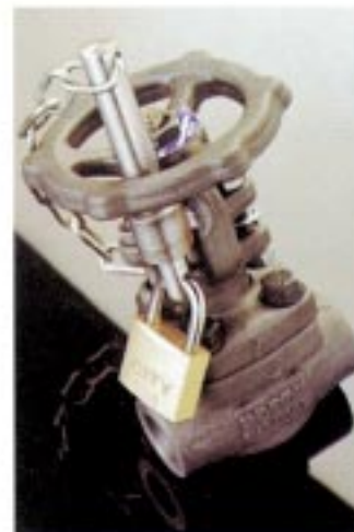
Vanne ou robinet : blocage par chaîne ou cadenas Gate or globe : locking system with chain or padlock
